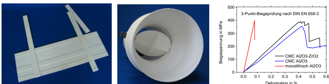
Abbildung 3: Hubtor und Heißgasklappe aus CMC mit quasi-duktilen Verhalten [6]
