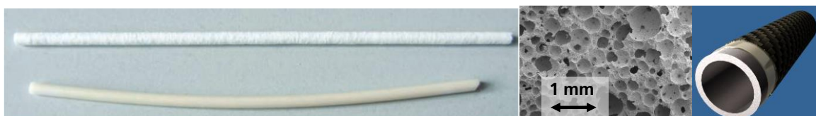
Abbildung 2: Poröse \text{Al}_2\text{O}_3 -Keramik (links oben) [3], keramische Schäume mit einstellbarer Porosität [4] und CMC-verstärktes Bauteil [5].
