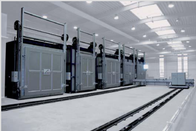
Abbildung 3: Kammerofenanlage für das Homogenisieren von Aluminium-Barren
