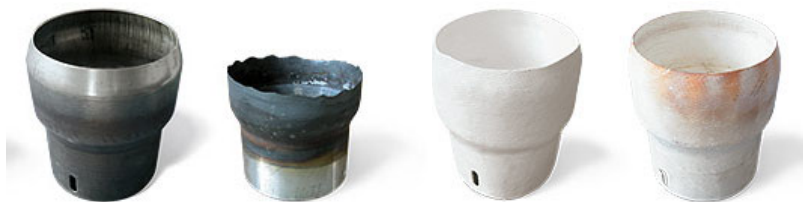
Flammrohr aus Stahl 1.4541 neu und nach 1.000 h Einsatz
