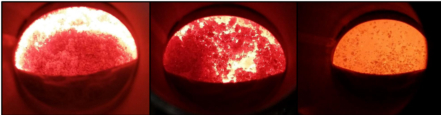
Abb.: Blick in den laufenden Induktionsschmelzer mit fortschreitender Zeit. Von links nach rechts: Gerade eingelegtes Gemenge auf der Schmelze, teilweise abgeschmolzenes Gemenge, Rauhschmelze mit Restquarz
