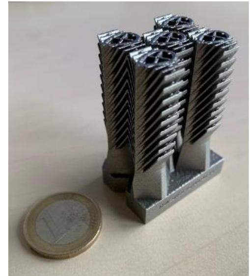
Additive Fertigung ermöglicht leistungsfähige und sichere Wärmeübertrager
