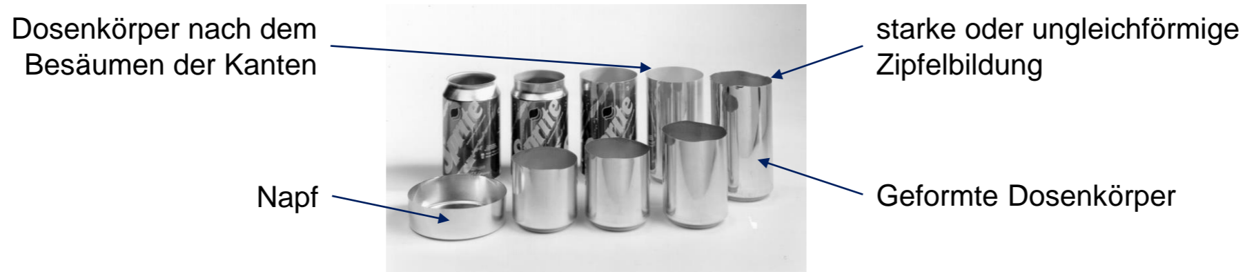
Zipfelbildung bei der Aluminiumdosenproduktion [Speira]
