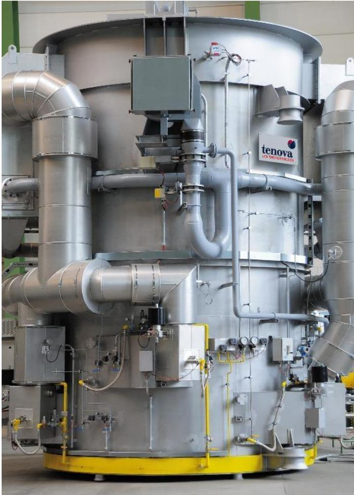
Höhere Luftvorwärmtemperaturen (bis 600°C)
