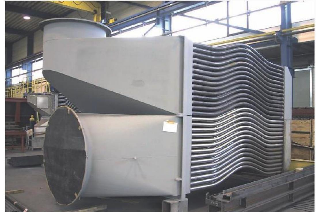
Abb.: Konvektiver Rohrbündelrekuperator der Firma Hülsenbusch Apparatebau GmbH & Co. KG
