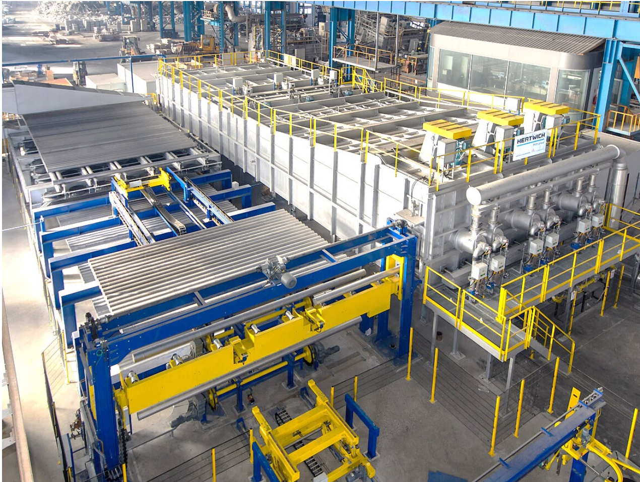
Bild 06: Kontinuierliche Homogenisierungslinie der Fa. Hertwich Quelle: www.hertwich.com/solutions
