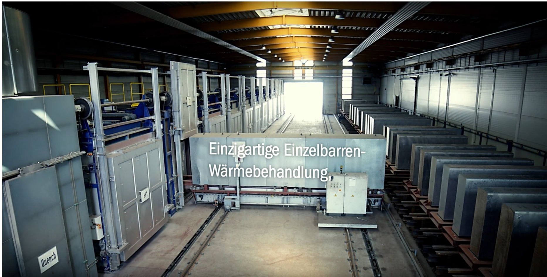
Bild 15: Realisierte Ofenlinie von BSN zum Homogenisieren von Aluminium-Barren / Quelle: www.gleich.de
