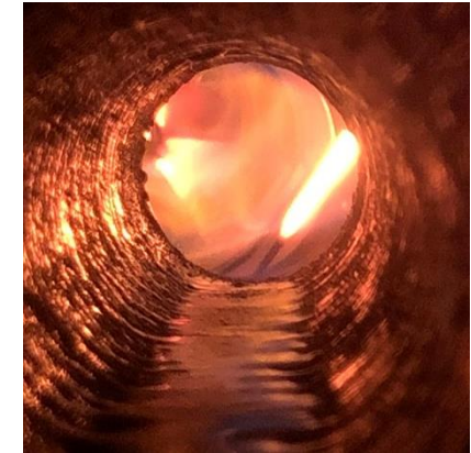
Abbildung: Glühen der Stauscheibe bei 180 kW und 100 Vol.-% H 2 .
