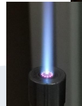
Glühen der Brennerdüse bei 100 Vol.-% H 2
